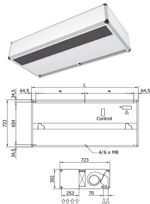
Construcción VW: ver dimensiones Windbox M-G
