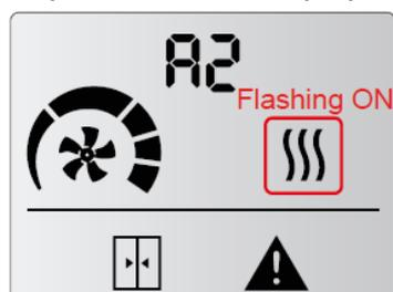
Le chauffage est bloqué et éteint. Il s'agit du programme de sécurité contre la surchauffe. Un technicien doit vérifier l'appareil et résoudre le problème pour éviter des dommages internes. Une fois résolu, réinitialiser l'appareil.
